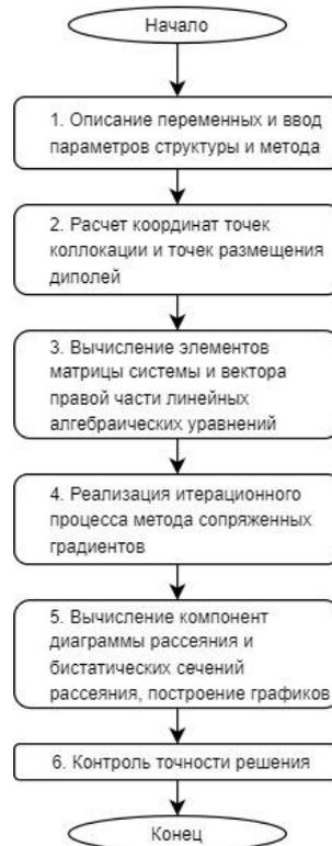
Рис. 2. Блок-схема компьютерной программы
