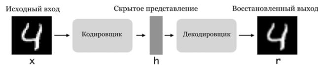
Рис. 4. Архитектура простого автокодировщика
