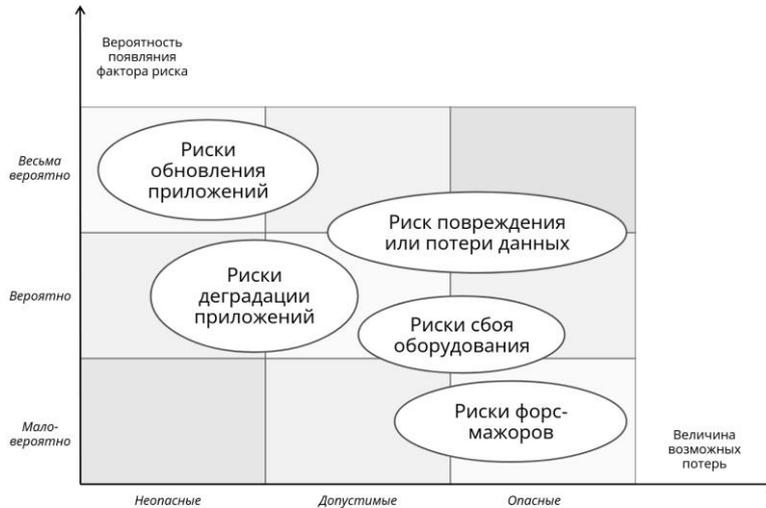
Рис. 2. Оценка рисков эксплуатации по матрице вероятности и последствий
